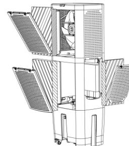
请先把两面侧百叶窗上的两个螺丝拧下，然后按下百叶窗上的扣件（五面湿帘的取出方法一样），打开百叶窗取下防尘网后，拿出湿帘。
