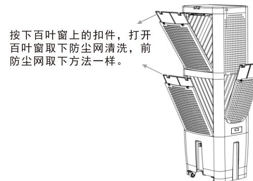
按下百叶窗上的扣件，打开百叶窗取下防尘网清洗，前防尘网取下方法一样。
