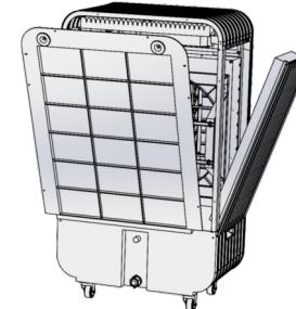
拔下电源插头，用螺丝刀把百页窗上的螺丝拧下，手握百页窗上部，轻轻往外拉(稍往上提)将湿帘组件拆下。
