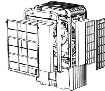
拔下电源插头，用螺丝刀把百页窗上的螺丝拧下，手握百页窗上部，轻轻往外拉(稍往上提)将湿帘组件拆下。
